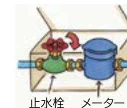
止水栓 メーター
