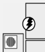
電気温水機器 (エコキュート)
